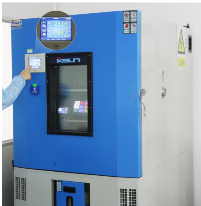
图 5-3 高低温老化测试图
